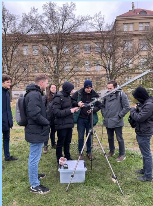
Monitorování rádiového provozu v pásmu VHF (YAGI anténa, SDR Winradio WR- G305e)
