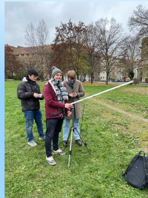
Monitorování rádiového spektra v pásmu UHF (YAGI anténa, Ruční stanice ICOM IC-R30)
