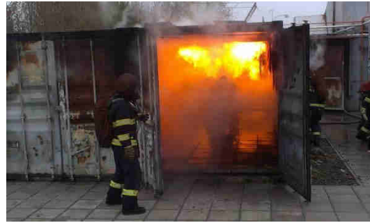
Test na hasičském polygonu ve „flashover“ kontejneru.
