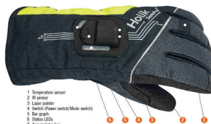
Chytrá rukavice s IR senzorem a termočlánekem.
