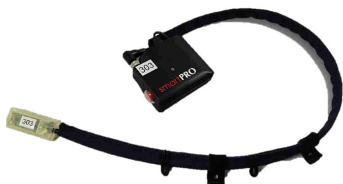
Modul senzorů pohybu + vyhodnocovací obvody.
