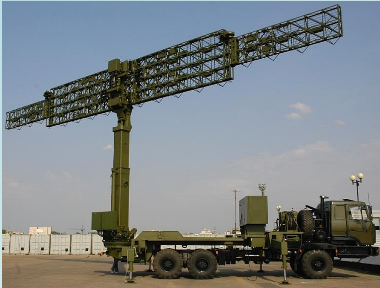
Vostok D/E Mobile 2-D metrový přehledový radiolokátor
