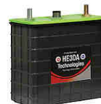
Baterie v ochranném obalu ENERGETICKÁ KAPACITA 1kWh, NAPĚTÍ 4V, KAPACITA 270Ah, Max. NABÍJENÍ 4.2V, Max. VYBÍJENÍ 2.0V, VÁHA 11,9kg
